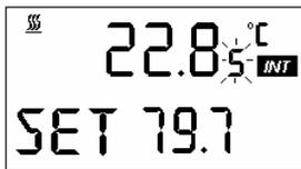
Anzeige der aktuellen Badtemperatur (oben) mit 0,05 °C Auflösung) und des Sollwertes (unten). Pumpe läuft an. Es werden die Werte übernommen, die vor dem Abschalten aktiv waren.
