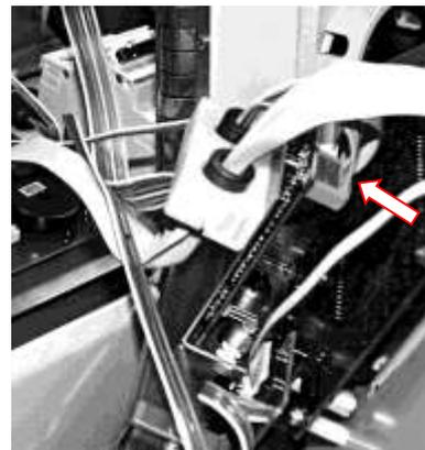
Steckverbinder A3/X5 lösen.
