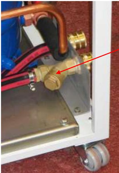
Verkleidungsblech an der rechten Seite abschrauben. Filtergehäuse mit z. B. Gabelschlüssel (SW 19 oder SW 27) öffnen, Drahtfilter herausziehen, reinigen und wieder in den Kühlwasserzulauf einsetzen. Deckel aufschrauben. Verkleidungsblech anbringen.
