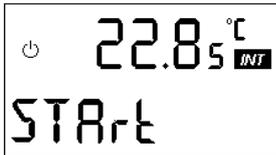
Der Geräteselbsttest läuft an. Alle Anzeigesegmente und Symbole erscheinen für ca. 1 s. Danach Anzeige der Softwareversion (VERx.x) für ca. 1 s.
